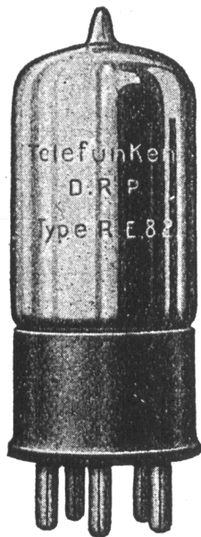
Abb. 146. Telefunken-Doppelgitterröhre mit Thoriumkathode, verspiegelt R. E. 82 (Anhang Nr. 35).
